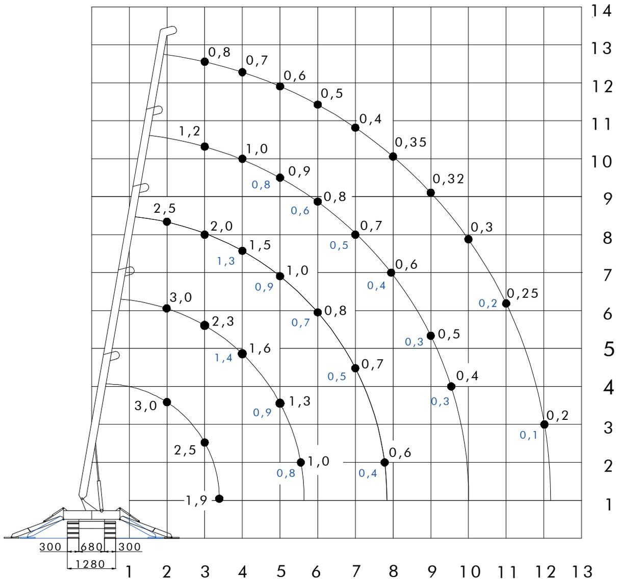
von den Traglasten ist das Gewicht von Haken und Anschlagmittel abzuziehen
